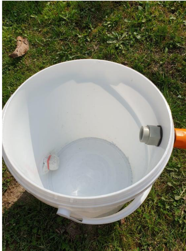
Obr. 5-2 První konstrukční verze kýble ze kterých je složen modulární filtr
