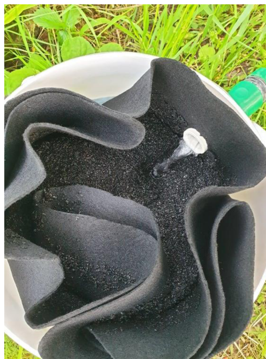
Obr. 5-4 Kýbl opatřený netkanou textilií a naplněn jemnou frakcí černého uhlí
