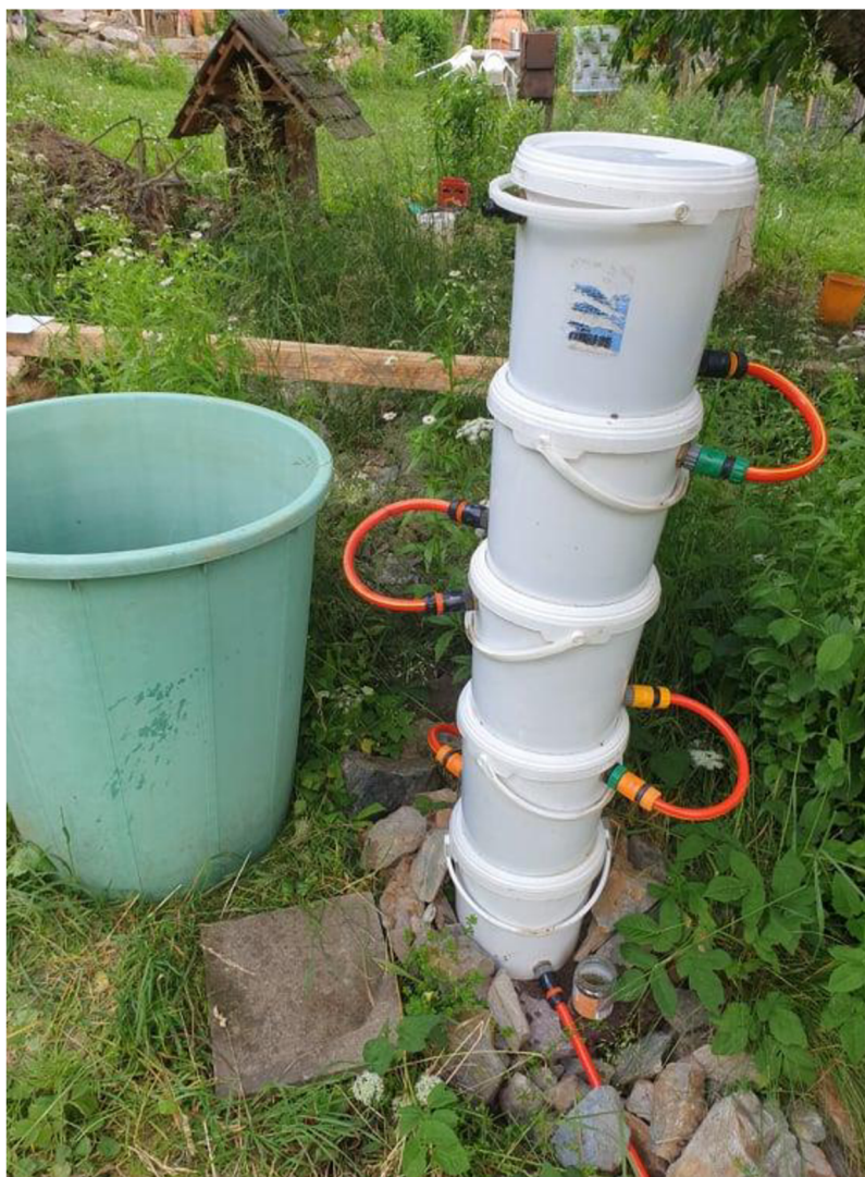
Obr. 5-5 Modulární filtr, sestupně od nejhrubší frakce po nejjemnější frakci
