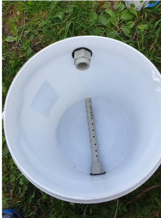
Obr. 5-3 Druhá konstrukční verze kýble ze kterých je složen modulární filtr
