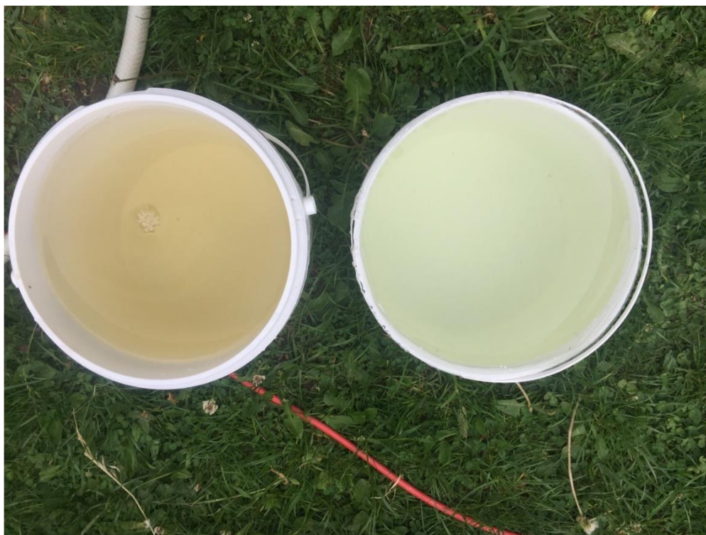
Obr. 5-1 Vlevo odpadní voda po odebrání z čistírny, vpravo odpadní voda přefiltrovaná přes modulární filtr
