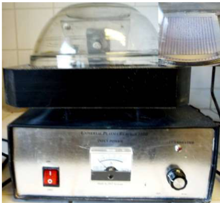
Obr. 12: Univerzální plazmový reaktor UPS 100W a detail elektrody pro generaci povrchového výboje (vpravo nahoře).
