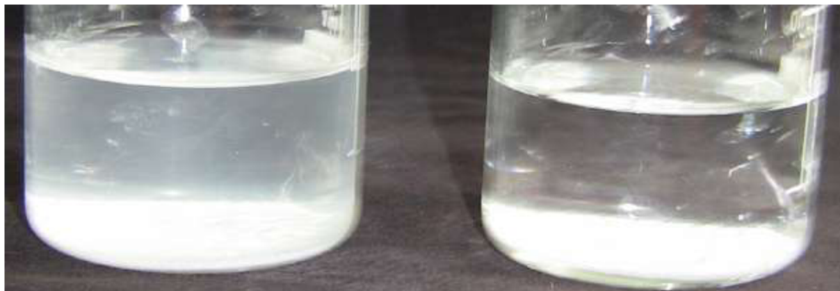
Obr. 13: Vodný roztok plniva po plazmovém opracování (vlevo), referenční vzorek (vpravo).
