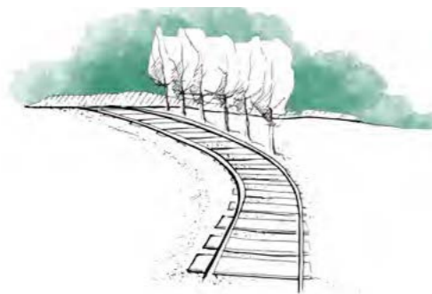
železnice na náspu
