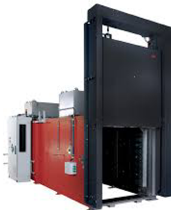
Obr. 23. Vozokomorová pec SVK 14000/45 s dveřmi ovládanými elektricky [9]
