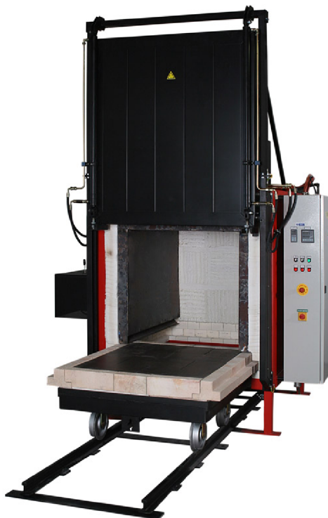
Obr. 24. Vozokomorová pec VKNC 9500/850 s dveřmi ovládanými hydraulickými písty [9]
