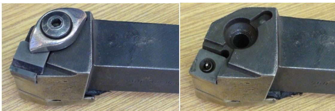
Obr. 2.9 Zařízení pro měření teploty vyměnitelné břitové destičky
