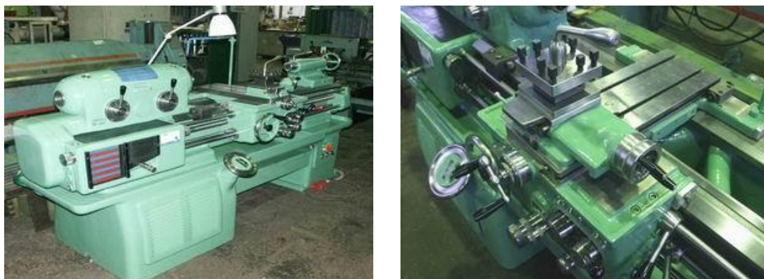
Obr. 2.1 Obráběcí stroj – soustruh SV 18 30
