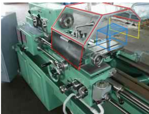
Obr. 3.10 Odstínění měřené součásti od rušivých elementů 30
