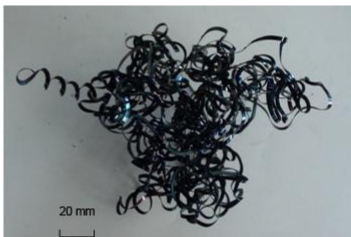
Obr. 3.21 Dlouhá nedělená tříska
