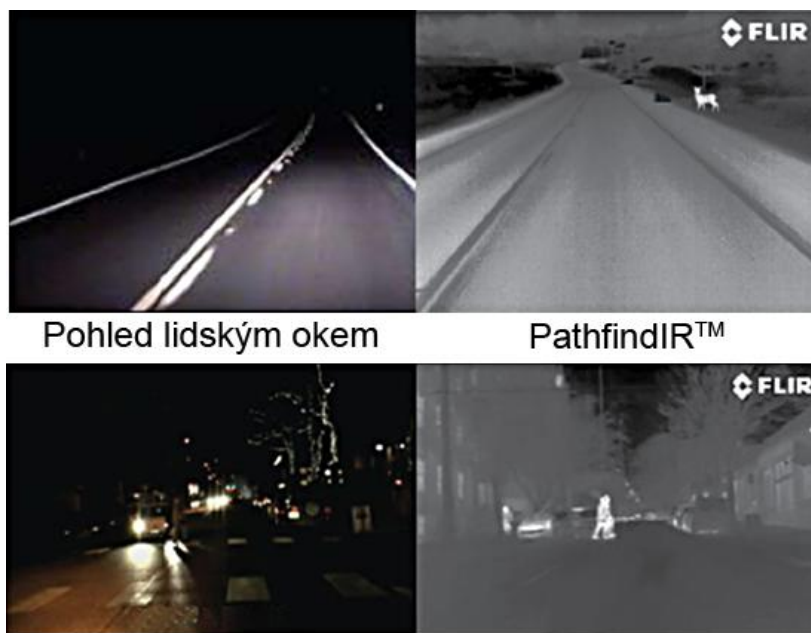
Obr. 1.9 Pohled bez a s použitím systému PathfindIR™ 8
