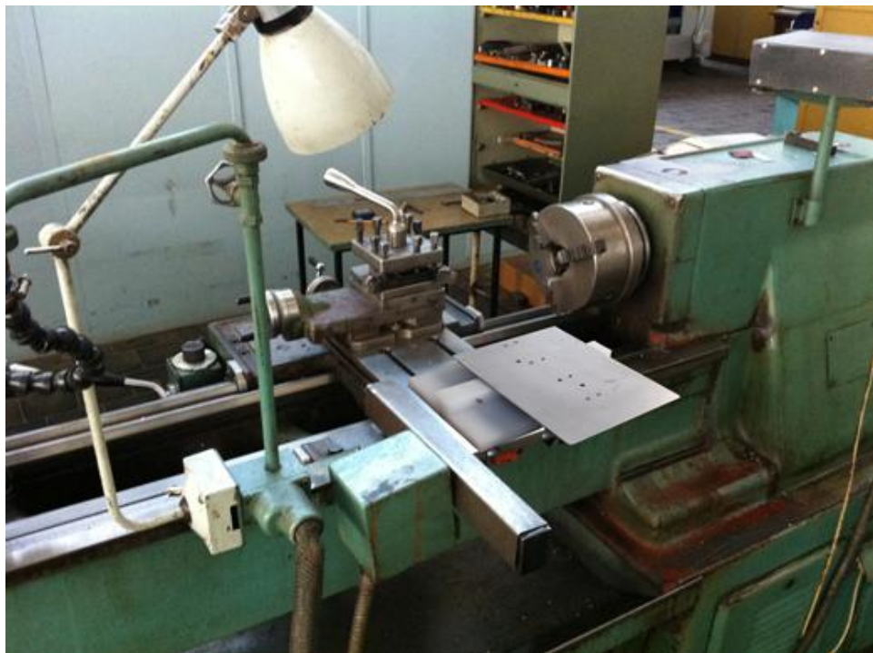
Obr. 3.12 Umístění přípravku na lože soustruhu SV 18
