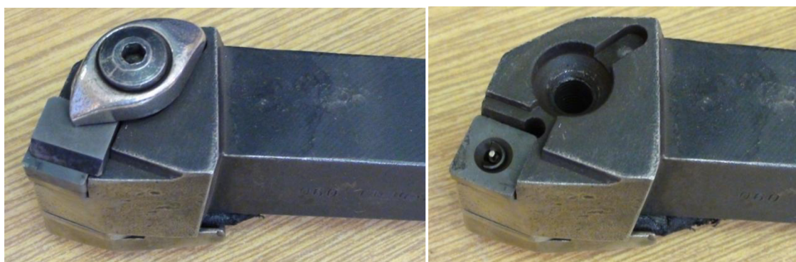
Obr. 2.9 Zařízení pro měření teploty vyměnitelné břitové destičky
