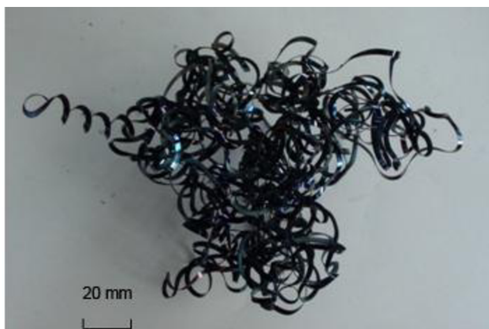
Obr. 3.21 Dlouhá nedělená tříska
