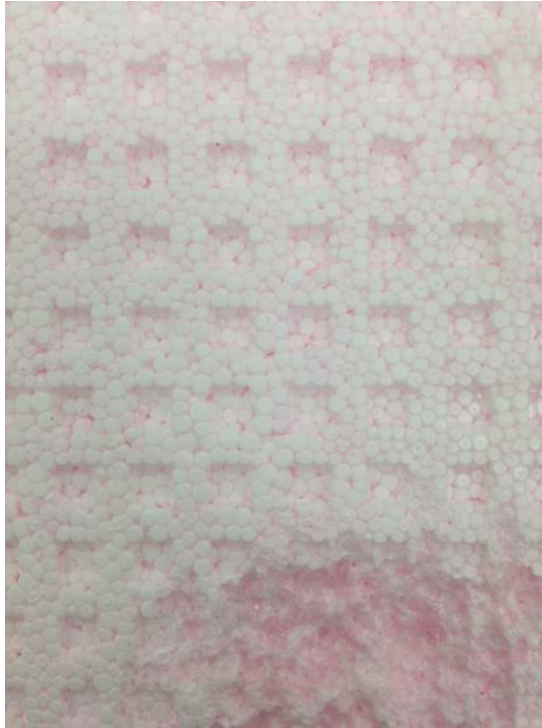
Obrázek 2.3 Aceton na polystyrenu (extrudovaný růžový)
