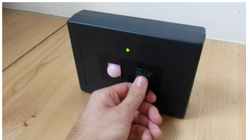
Obrázek 7.3: Rozsvícení LED diody umístěné na demonstračním modulu terminálu při sejmutí autentizovaného otisku prstu.
