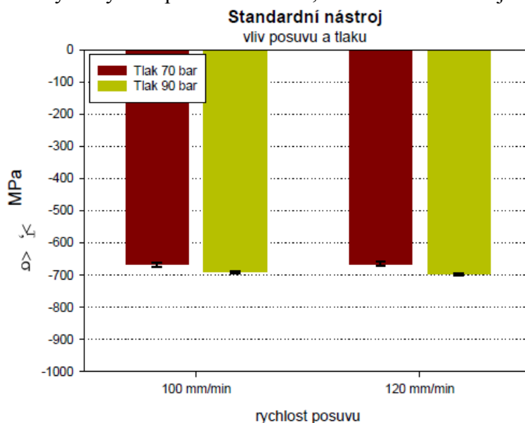
Obr. 62 Vliv posuvu a tlaku na zbytkové napětí pro standardní nástroj.
