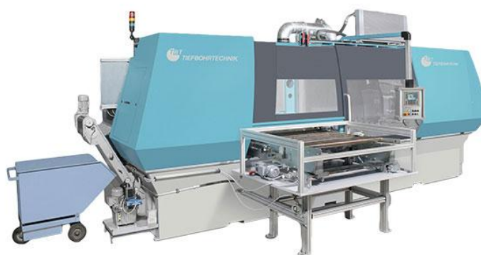
Obr. 19 Stroj TBT pro hluboké vrtání 18 .
