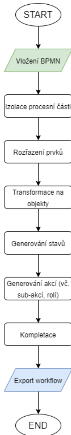
Obrázek 34: Logické schéma transformace BPMN (Zdroj: Vlastní zpracování)
