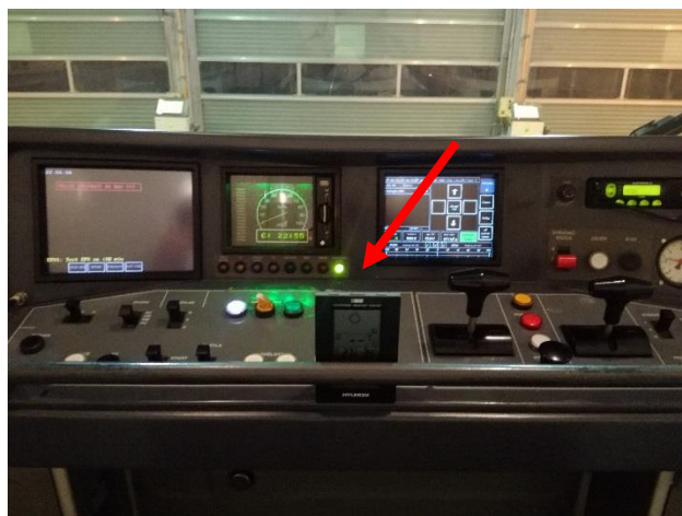
Obr. 12 – Umístění meteostanice na řídicím pultu
