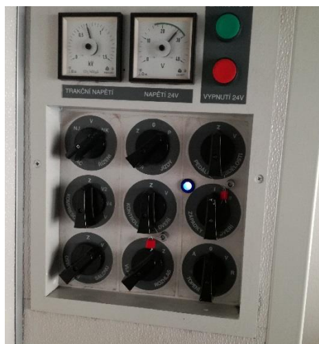
Obr. 10 – Panel nouze s vyznačeným přepínačem topení, ventilátor
