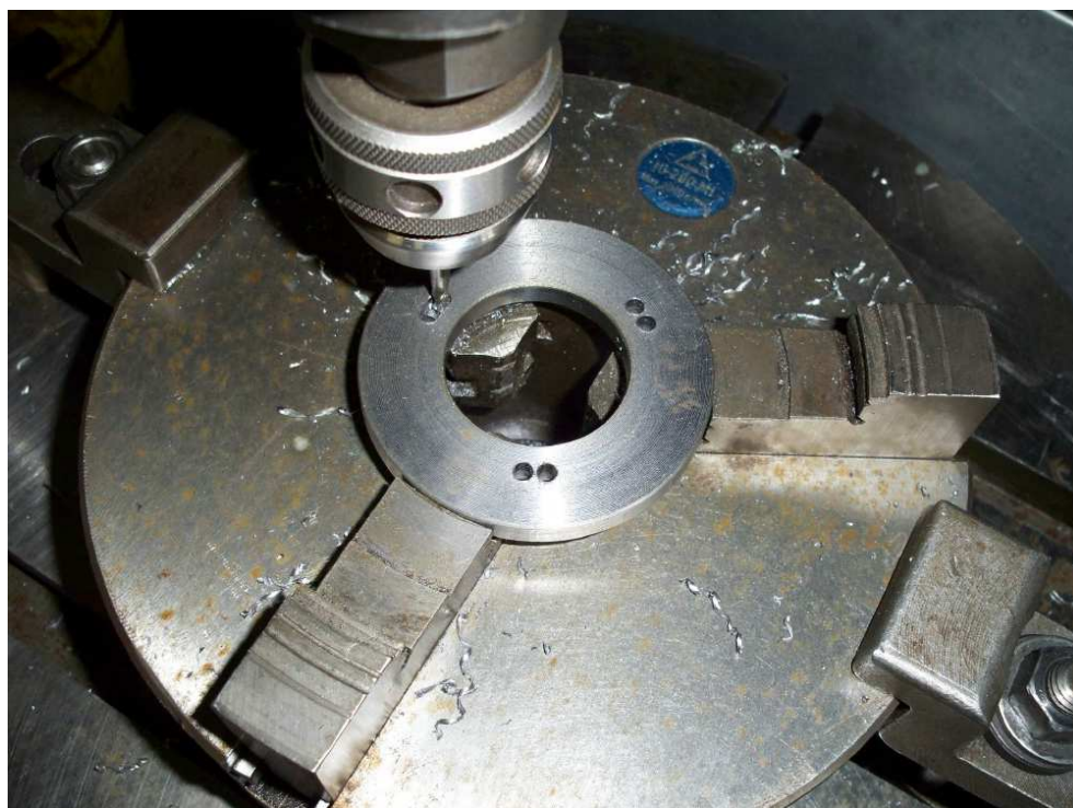
Obr. 69 Frézování obloukových drážek
