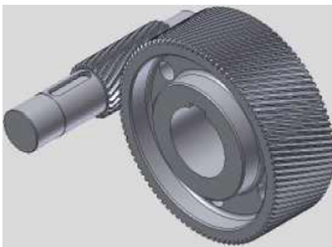
Obr. 7 Čelní ozubené soukolí vnější se šikmými zuby [3]
