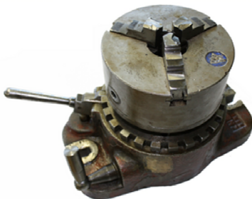
Obr. 34 Jednoduchý dělicí přístroj s vodorovným a svislým upínáním [33]
