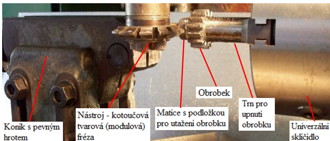
Obr. 64 Upnutí trnu s obrobkem
