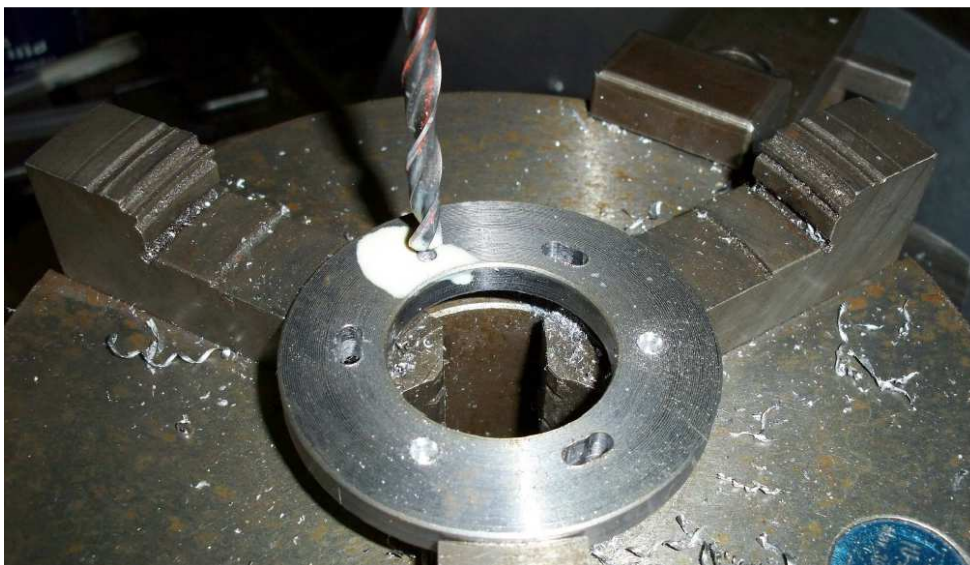
Obr. 70 Vrtání otvorů pro šrouby
