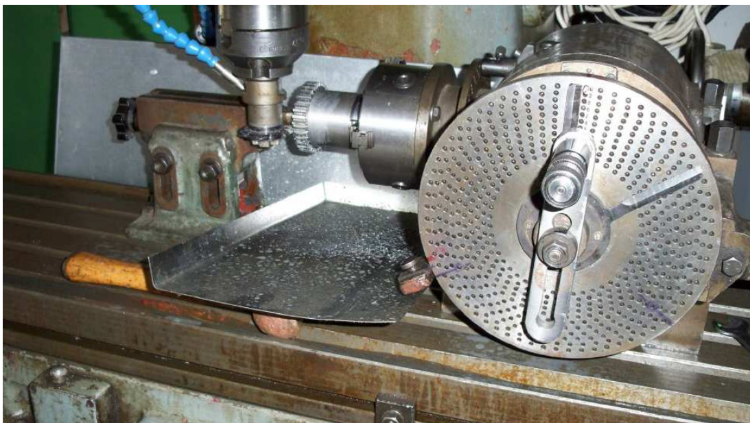
Obr. 72 Frézování velkých ozubených kol
