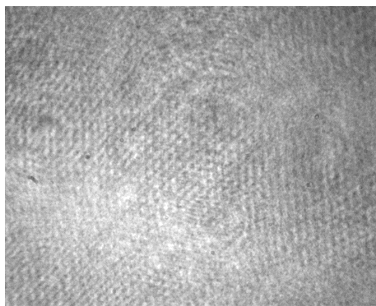
Obrázek 36: Gaussovské pole. Struktura na obrázku je nejspíše způsobena prachem na kameře nebo pixely kamery, gaussovské pole nemá strukturu.
