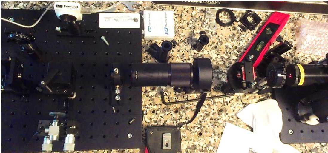
Obrázek 22 : Sestava Michelsonova interferometru pro interferometrii nedifrakčních svazků.
