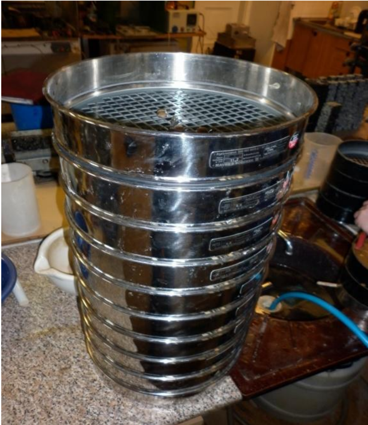
Obrázek 13 - laboratorní sestava sít sloužící ke stanovení zrnitosti - zdroj: vlastní
