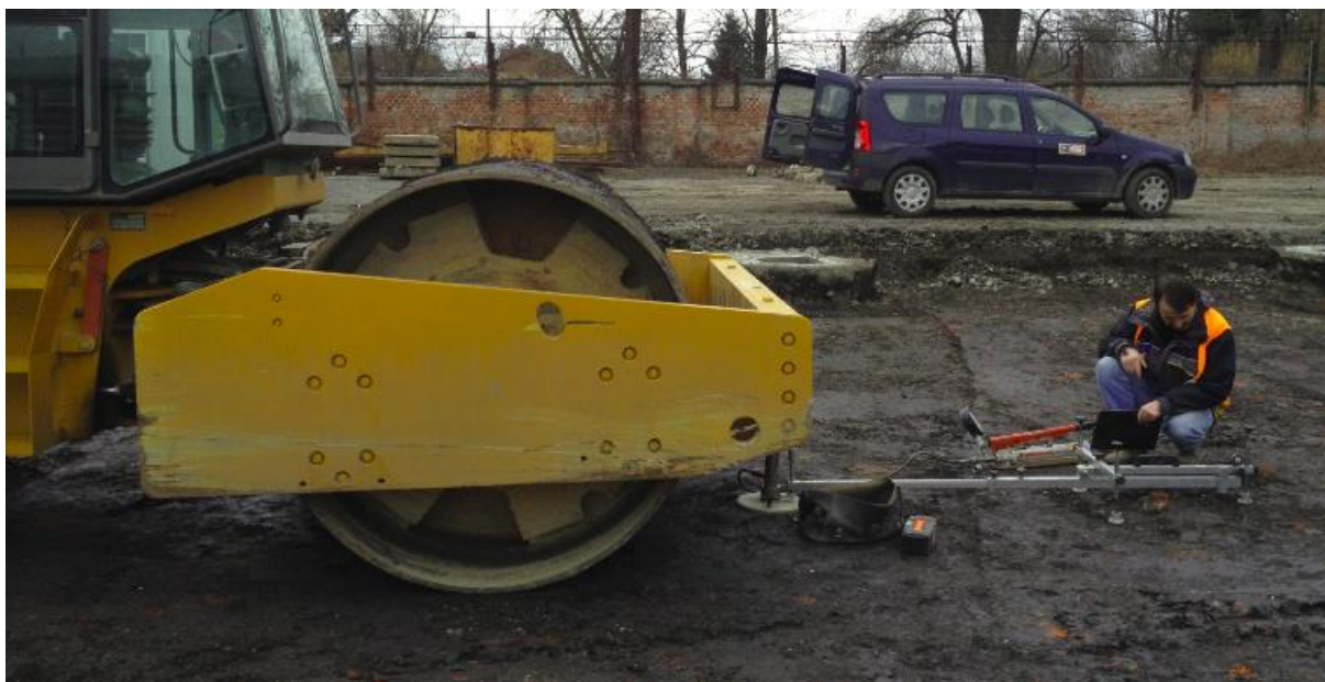
Obrázek 12 - provádění statické dynamické zkouška - zdroj: vlastní
