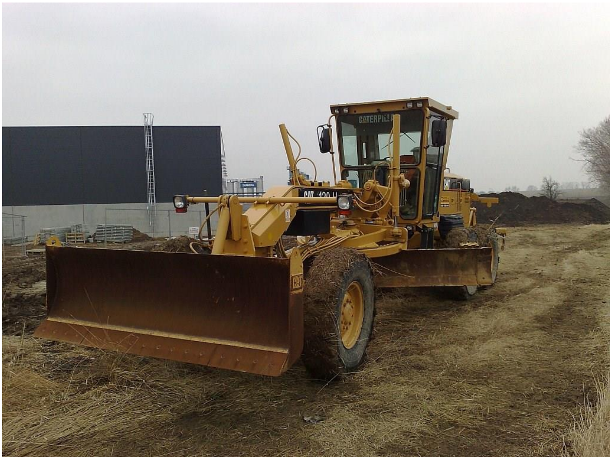
Obrázek 10 - grejdr použitý na stavbě - zdroj: vlastní
