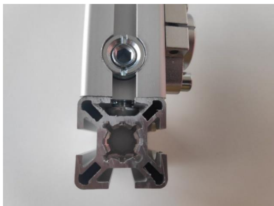
Obr. 31 Konstrukční propojení extrudovaných profilů [vlastní]
