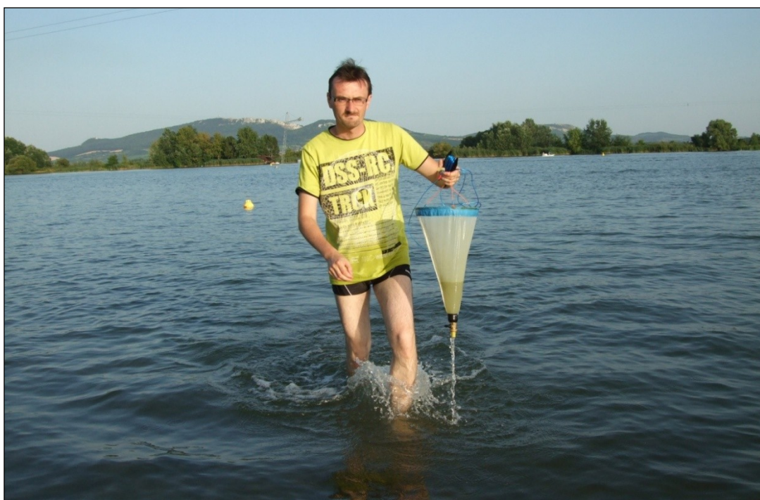
obrázek č. 12 – Použití planktonní sítě při vlastních algologických odběrech vzorků
