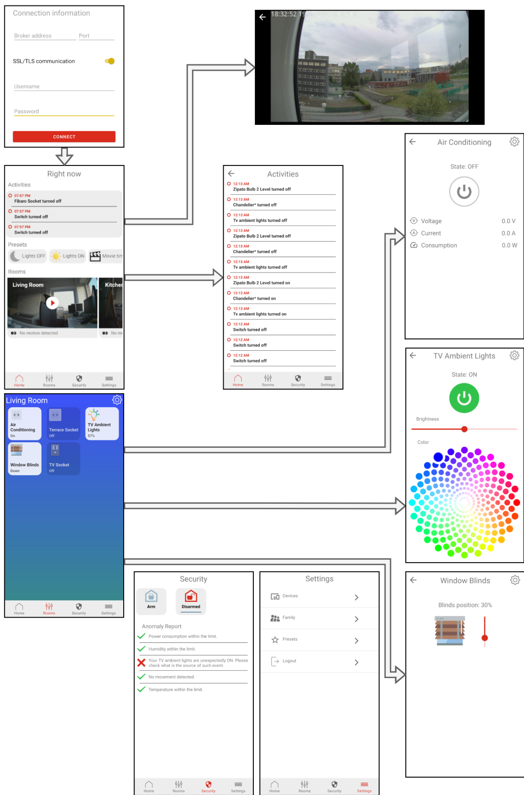
Obr. 5.13: Ukážka navigačného grafu aplikácie. Jednotlivé zobrazenia sú destinácie a prechody medzi nimi sú navigačné akcie.
