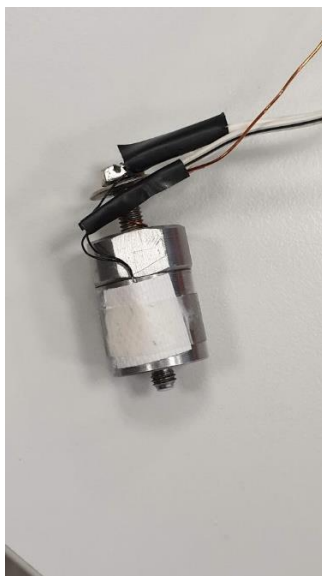
Obr. 16 – Připevnění termistoru k vibračnímu snímači
