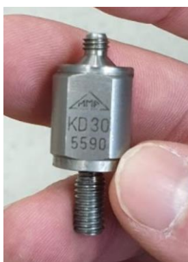
Obr. 9 – Snímač vibrací (akcelerometr) MMF KD30 v.č. 5590
