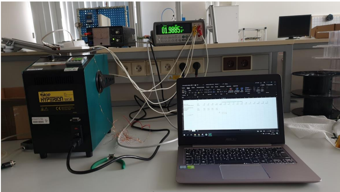
Obr. 15 – Pracoviště pro cejchování snímače teploty
