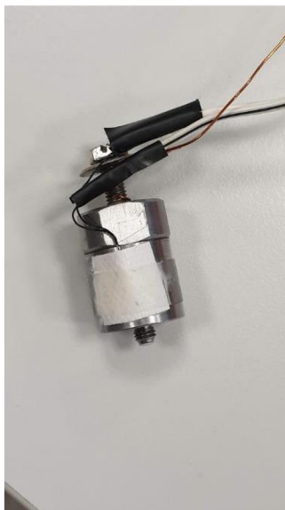
Obr. 16 – Připevnění termistoru k vibračnímu snímači
