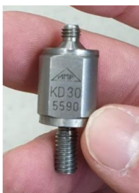
Obr. 9 – Snímač vibrací (akcelerometr) MMF KD30 v.č. 5590
