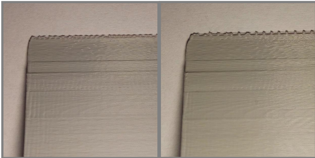
Obr. 7 Chyba tlače hranového prvku g-kódu Simplify3D_10 %
