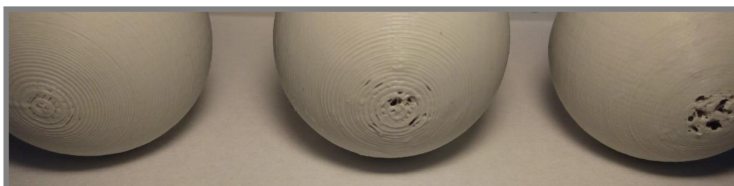
Obr. 44 Kvalita tlače vrcholov jednotlivých guľových prvkov
