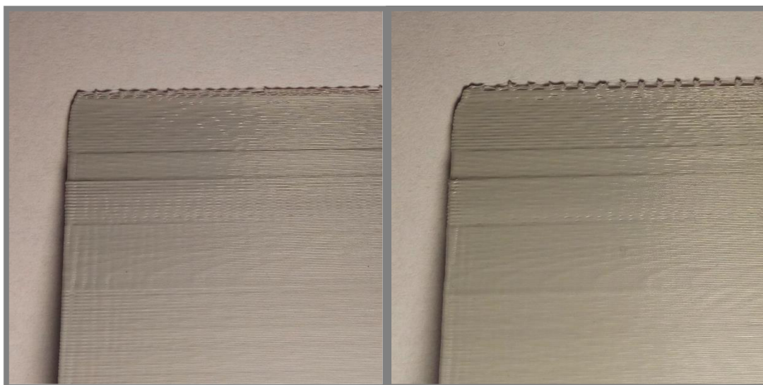
Obr. 7 Chyba tlače hranového prvku g-kódu Simplify3D_10 %
