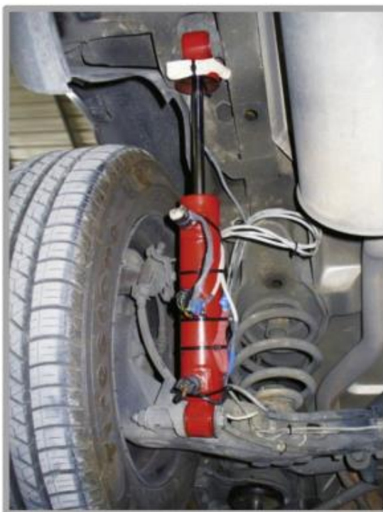
Obr. 6.4: Měřicí aparatura přidělaná k tlumiči [15]
