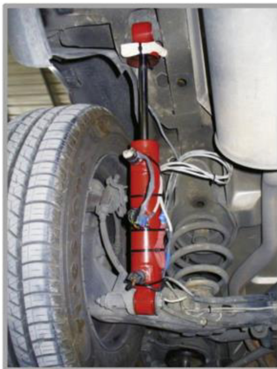
Obr. 6.4: Měřicí aparatura přidělaná k tlumiči [15]
