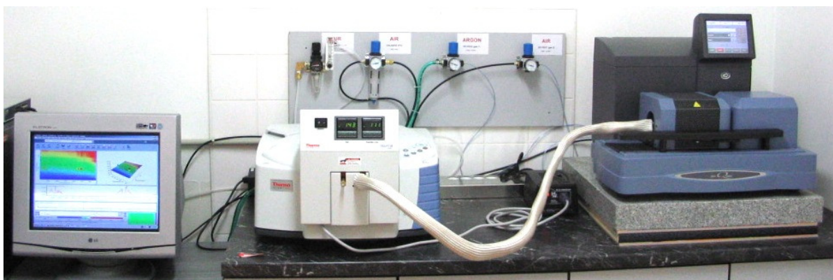
Obrázek 18: Uspořádání termické analýzy (zleva monitor, IR- analyzátor Thermo Nicolet iS10, TG-DTA TA Instruments SDT Q600, propojené vyhřívanou kapilárou
