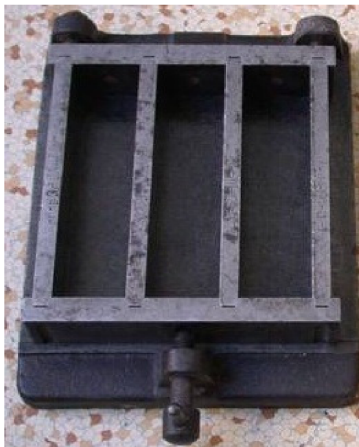
Obrázek 11: Forma pro přípravu zkušebních trámečků 40 \times 40 \times 160 mm
