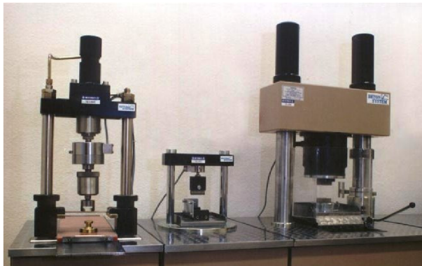
Obrázek 14: Lis pro zkoušku cementových zkušebních těles s lamačkou BS-310
