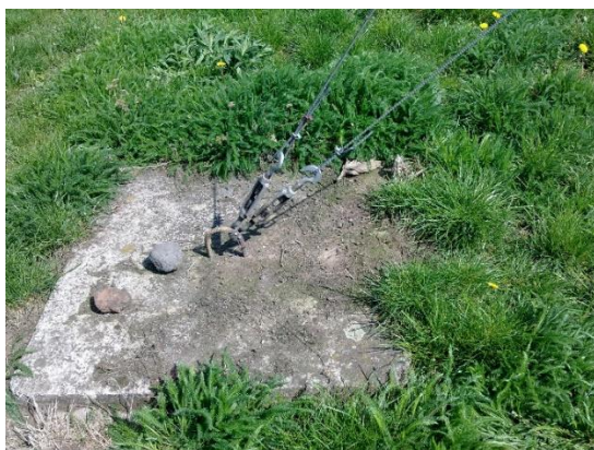
Obr. 56 Betonový panel sloužící jako kotva pro lana upnutá na sací pasti (Fryč David)
