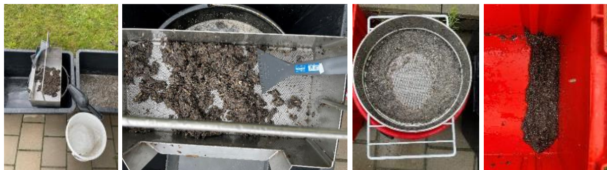
Obr. 38 Postup manuálního dvoustupňového prosévání PCK
