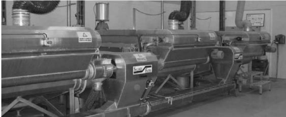
Obr. 3 Rotující pásová síta (Salsnes Filter SF6000) se síty o velikosti 0,35 mm (Rusten & Ødegaard, 2006)
