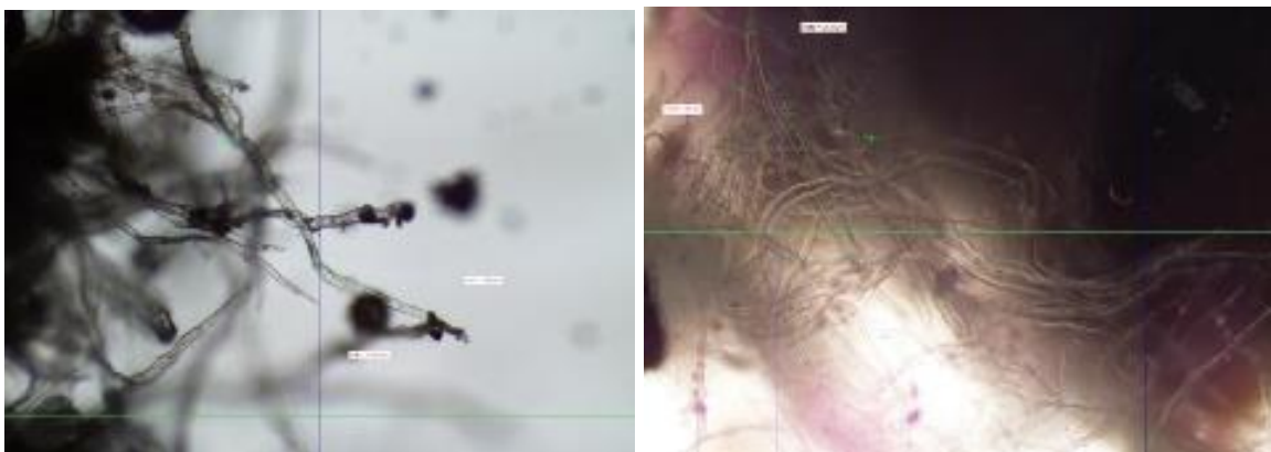
Obr. 45 Černobílé a barevné fotografie vláken při zvětšení x200 se změřenou délkou vláken 0,243 mm a tloušťkou 0,0045 mm
