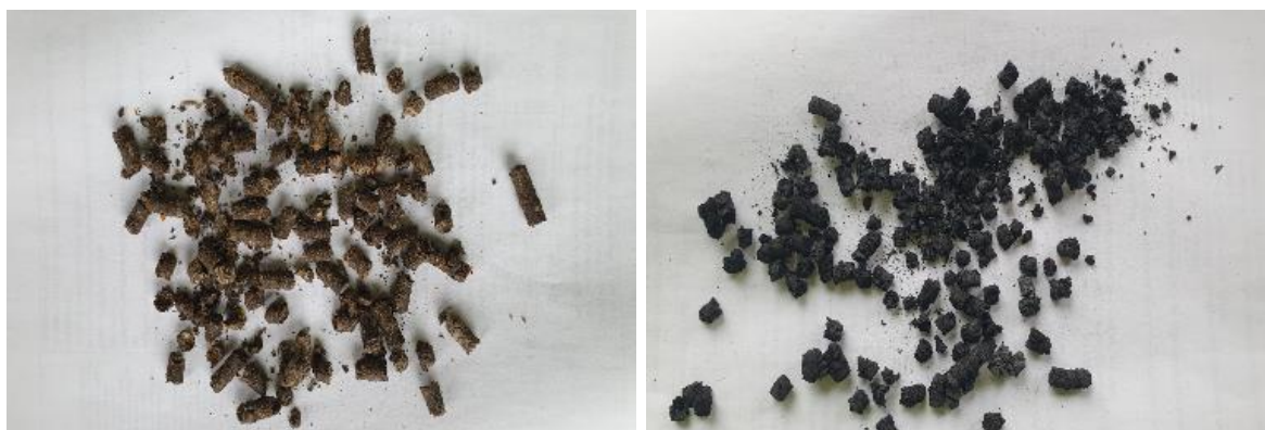
Obr. 46 CP před STP (vlevo) a pevný PUP po pyrolýze (vpravo)
