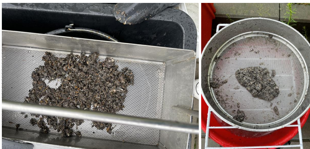
Obr. 31 Laboratorní síta z nerezové oceli: s velikostí ok 2 mm (vlevo) a s velikostí ok 0,4 mm (vpravo)
