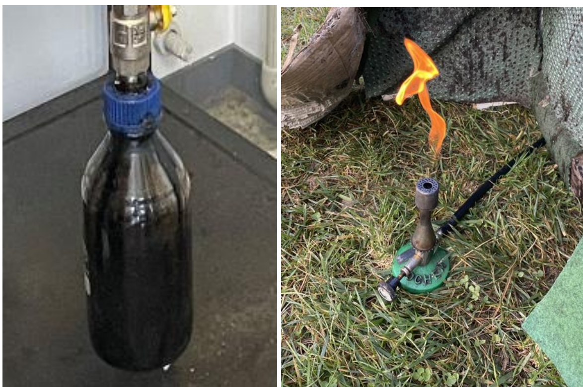
Obr. 47 Materiálová transformace CP procesem pyrolýzy na PO (vlevo) a PP (vpravo)
