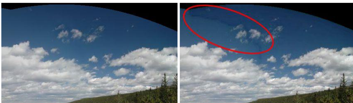
Obrázek 7.4: Porovnání dvou blenderů. Nalevo je výřez fotografie s použitím multi-band blendingu a napravo je výřez fotografie s použitím feather blendingu. Zejména si pak povšimněte jasně viditelného přechodu na pravé fotografii označeného červenou elipsou.
