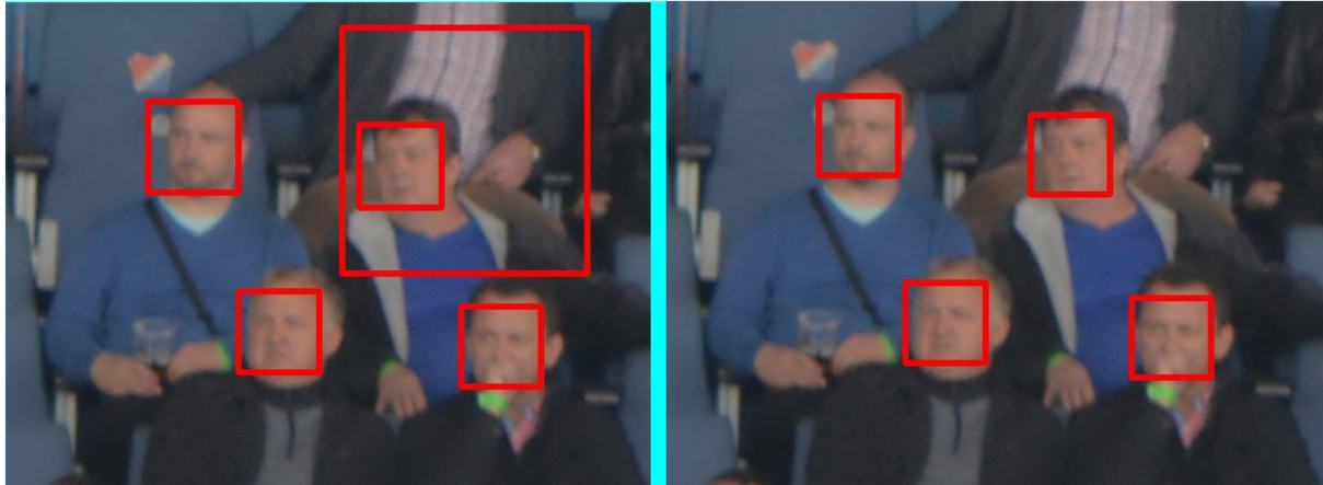
Obrázek 7.8: Porovnání dvou výřezů fotografií, nalevo bez použití odstranění extrémních a překrývajících se obdélníků, napravo s použitím.
