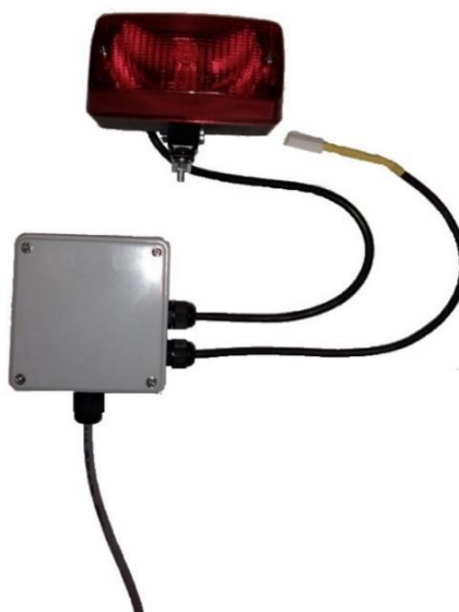
Obrázek 25 - Reálné zapojení světelné signalizace a koncového spínače
