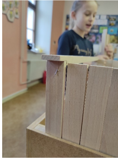
Obrázek 47 Hřebík, který vylezl při spojování bukového dřeva Zdroj: vlastní
