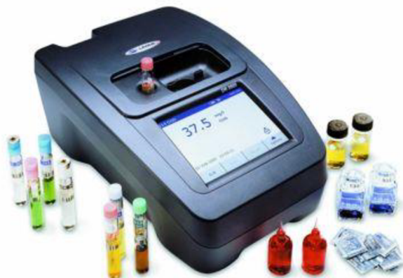
Obrázek 29: Spektrometr Hach Lange DR 2800. [89]
