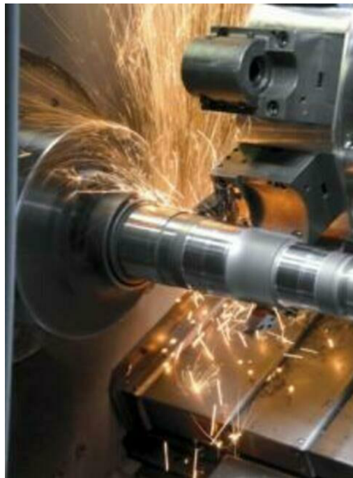
Obr. 10 Odoberanie triesok pri HSC obrábaní [26].
