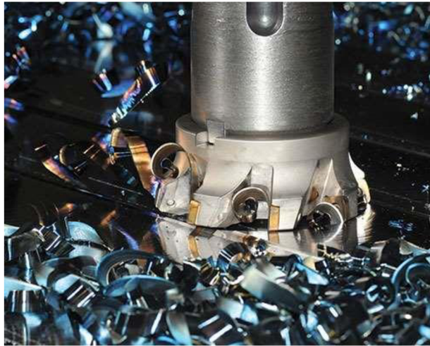
Obr. 11 Vysokoposuvové frézovanie frézou s VBD [27].
