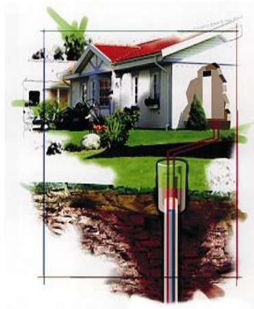
Obr. 6 Schéma napojení hloubkových vrtů pro tepelné čerpadlo
