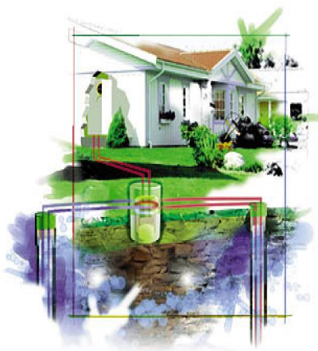
Obr. 7 Schéma napojení otevřeného systému na tepelné čerpadlo
