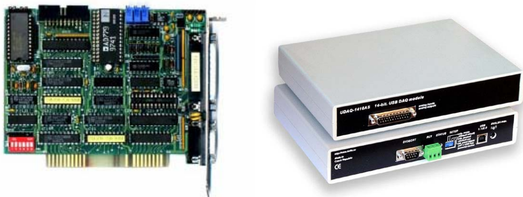
Obr. 12 Vlevo - měřicí karta Tedia PCA-1208, vpravo měřicí karta Tedia UDAQ 1416AS [17]
