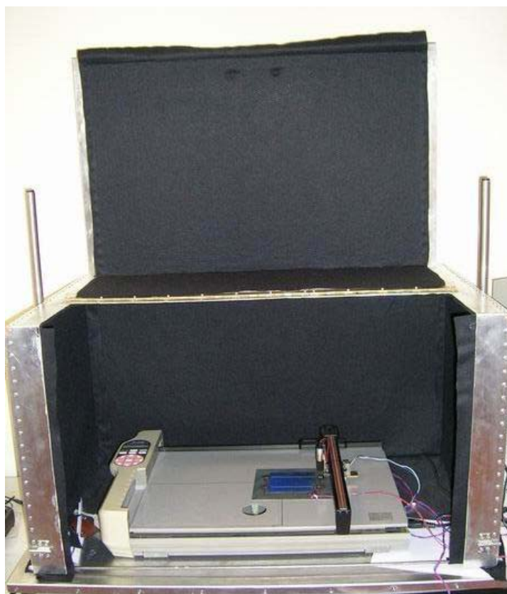
Obr. 10 Celkový pohled na skenovací zařízení s hliníkovým krytem
