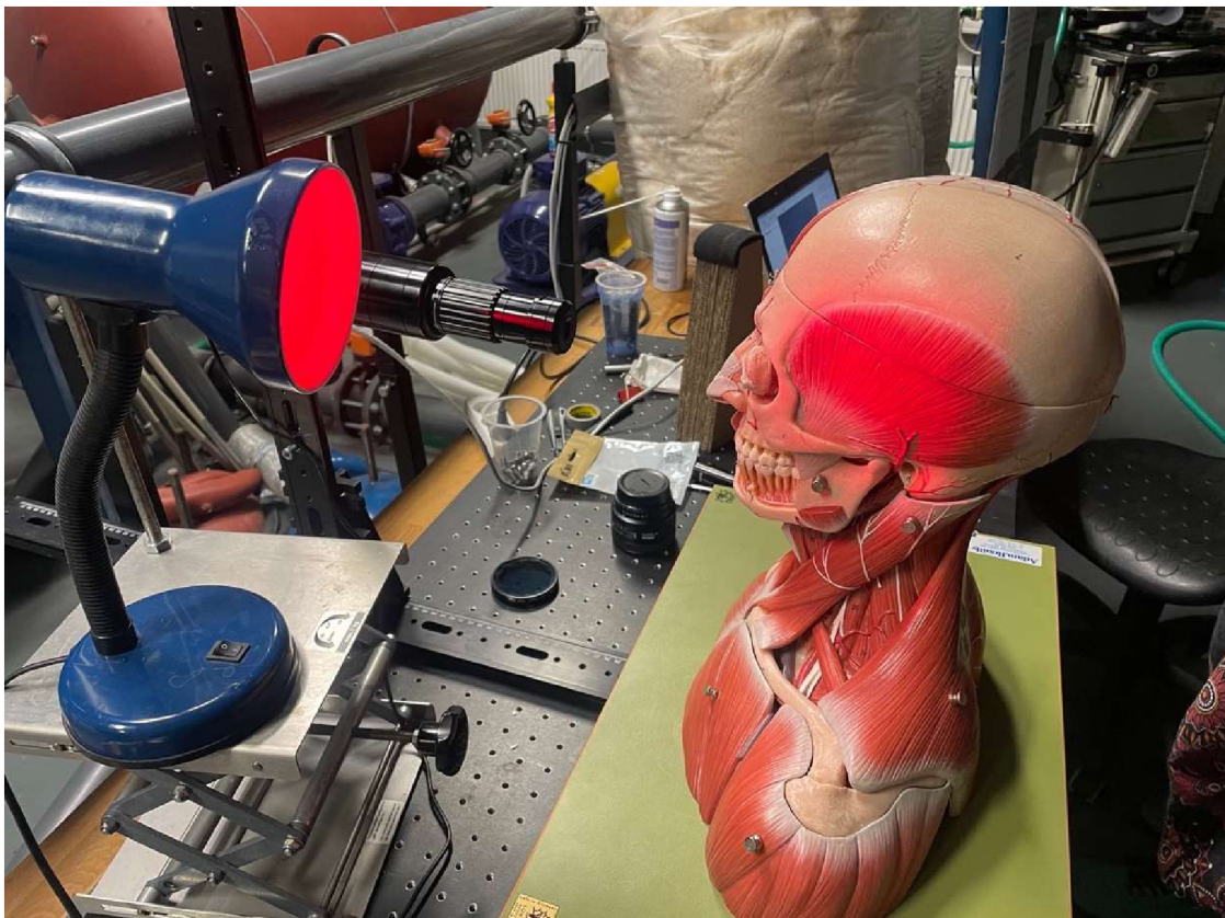
Obr. 8 Soustava s červeným osvětlením a objektivem InfiniProbe TS-160 (Autor)
