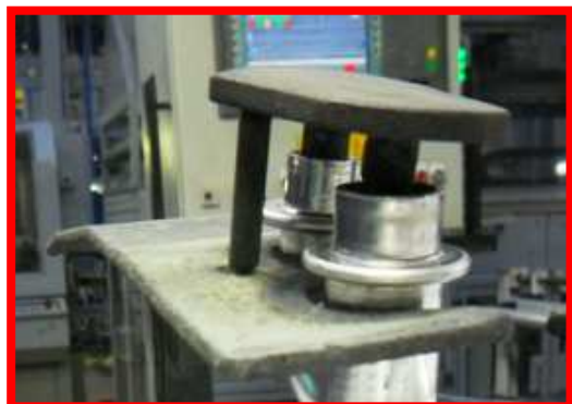
Obrázek 30: Aretační kolík nedosáhne do otvoru v podpěře
