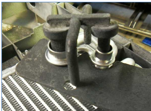
Obrázek 34: Násilná montáž staré letovací krytky
