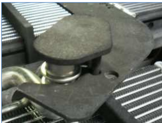
Obrázek 31: Příklad úpravy podpěry pro uni-čepičku
