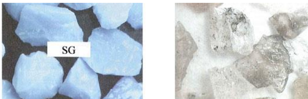
Obr. 3.12 Broušící zrna SG-korundu (nalevo) a broušící zrna abral-korundu (napravo) [5].
