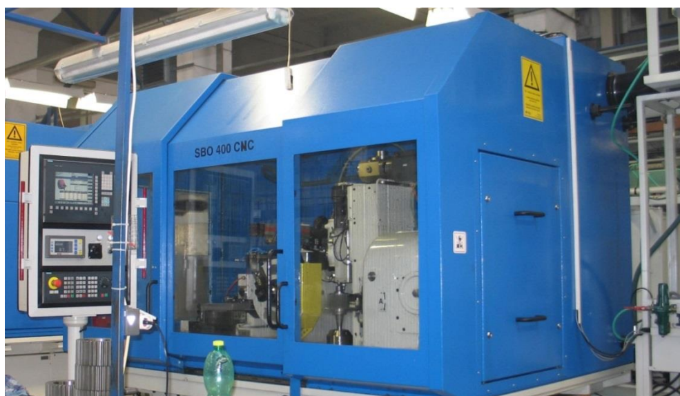
Obr. 5.7 Odvalovací bruska Gearspect SBO 400 CNC.
