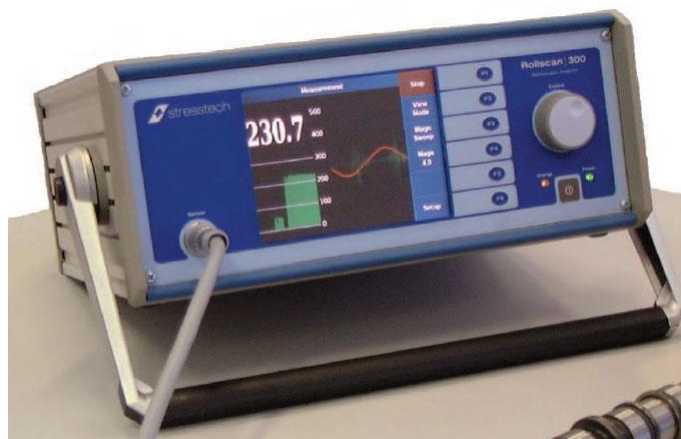
Obr. 5.5 Analyzátor Rollscan 300 firmy Stresstech [54].
