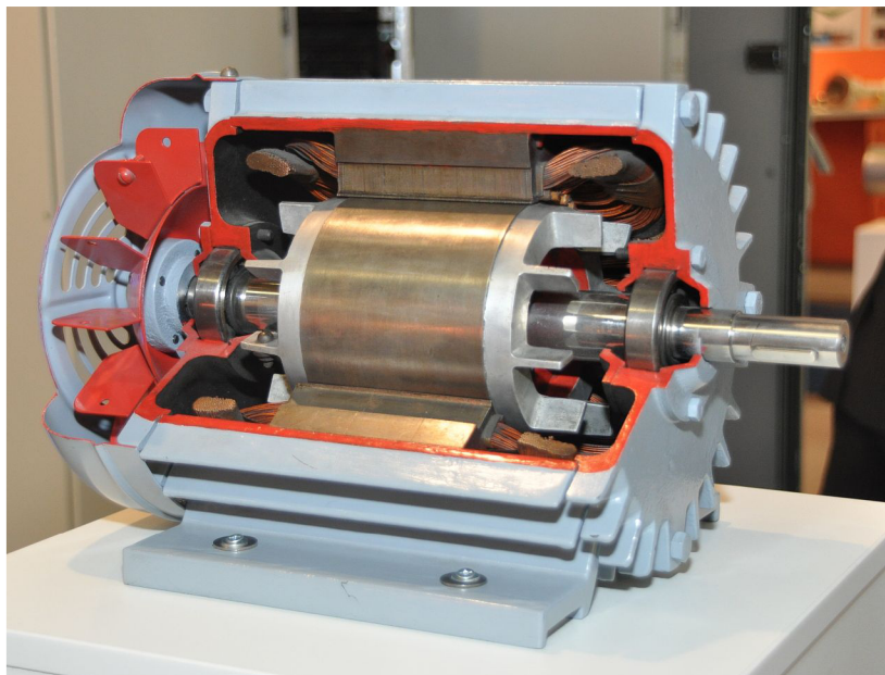
Obr. 1.1: Řez asynchronního motoru [9]
