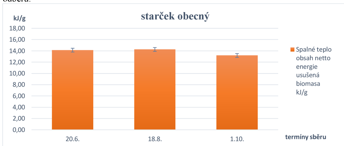
Graf 39. Hodnoty spalného tepla ( \text{kJ/g} ) v sušíně biomasy starčku obecném v závislosti na termínu odběru.
