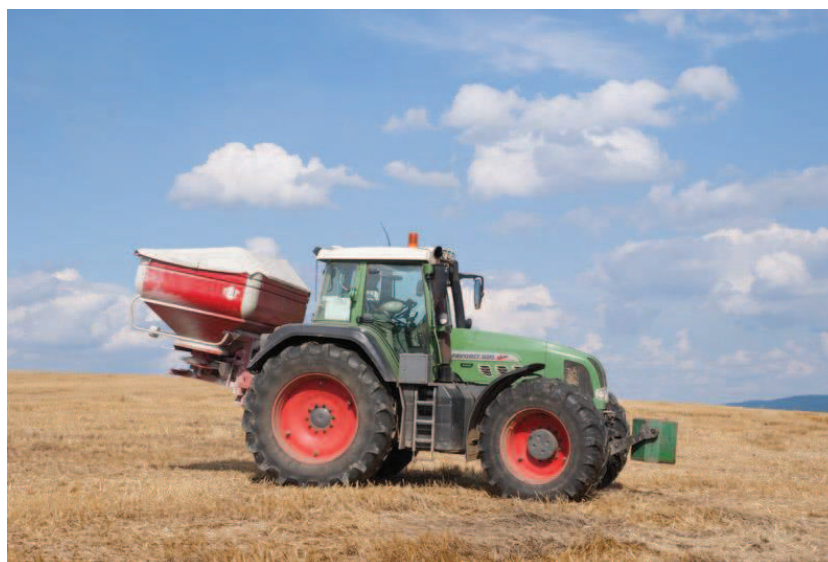
Obrázek 2 - Aplikace minerálního hnojiva na strniště pomocí neseného rozmetadla.
