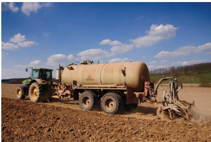
Obrázek 1 - Aplikace tekutých statkových hnojiv pomocí radličkového kypřiče do půdy (CRS - Marketing s.r.o., 2015).
