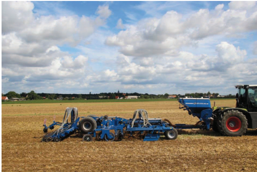
Obrázek 14- Secí stroj Köckerling Master umožňuje výsev obilovin i širokořádkových plodin. (Köckerling GmbH & Co. KG)
