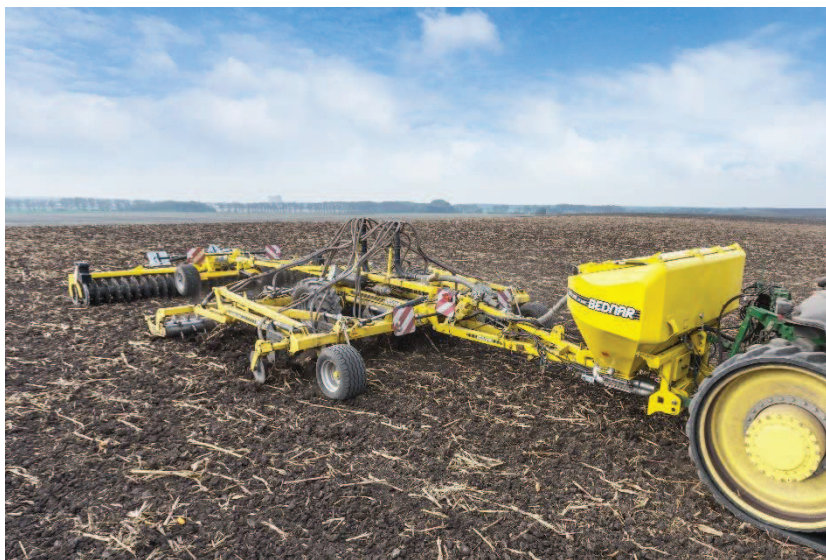
Obrázek 11- Hloubkový kypřič v kombinaci se zásobníkem pro aplikaci hnojiva do depa.
