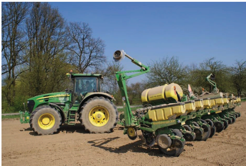
Obrázek 4- Přesný sečí stroj John Deere umožňující uložení hnojiva pod patu.
