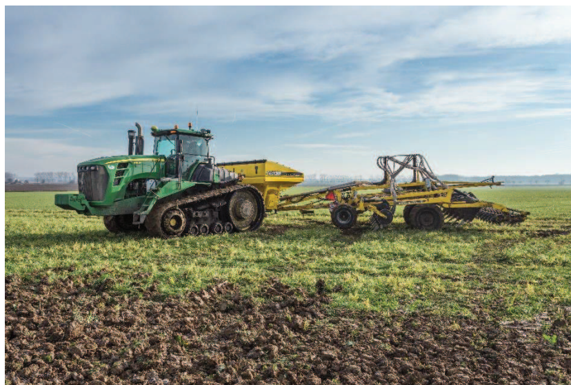
Obrázek 17 - Souprava pásového traktoru, zásobníku a dlátového kypříče při zakládání pokusných parcel.
