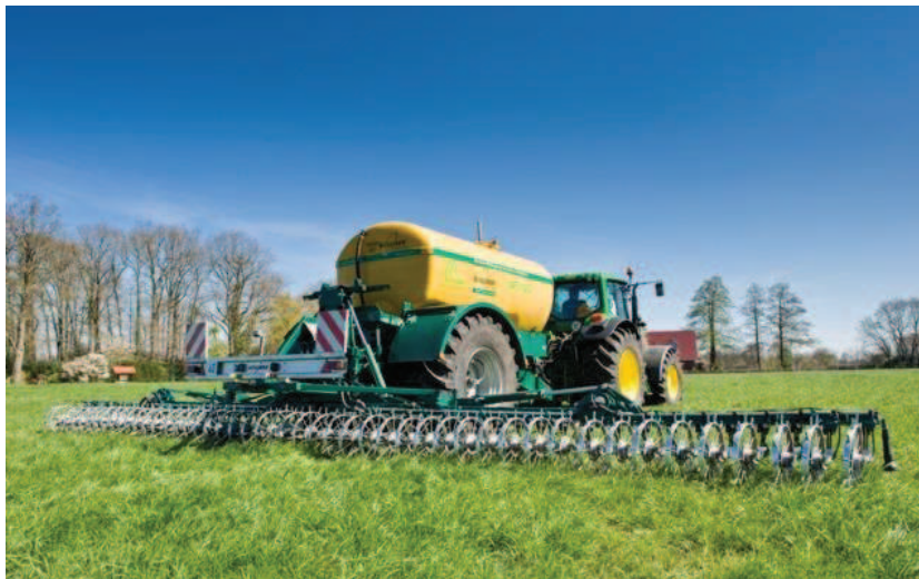
Obrázek 6 - Aplikace tekutého dusíkatého hnojiva metodou CULTAN na trvalých travních porostech (Güstrower L-M-B GmbH & Co.KG, 2015).
