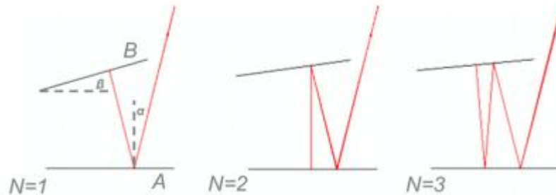
Obrázek 2: Konstrukce a princip funkce dvojitého zrcadla [23]
