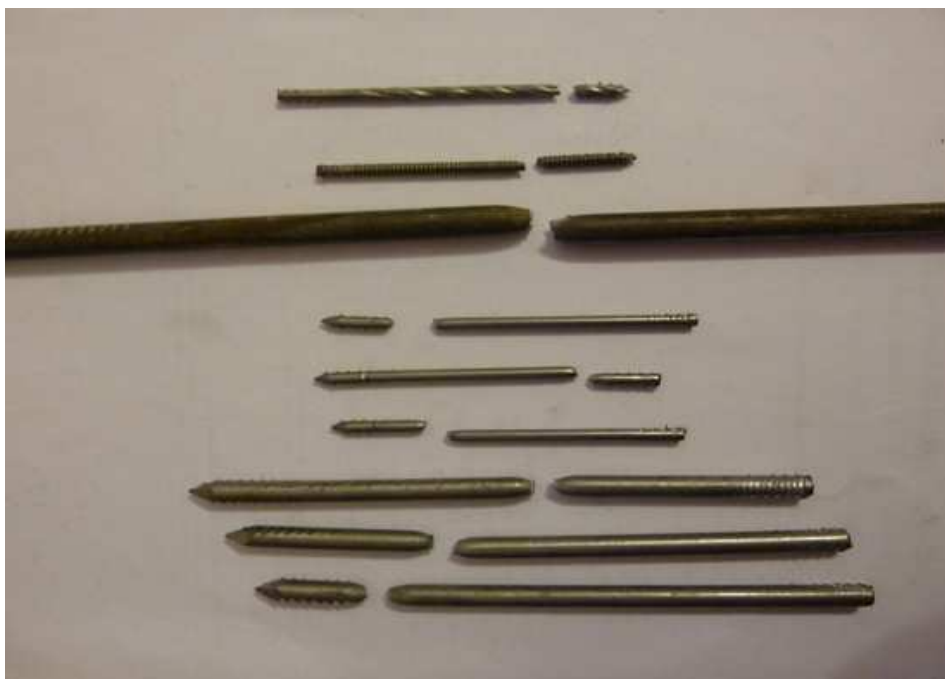
Obrázek 48 Ocelové vzorky po tahové zkoušce
