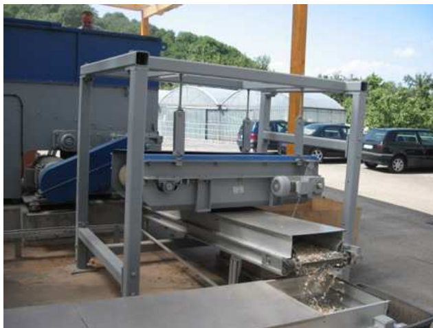
Obrázek 26 Příklad začlenění magnetického separátoru v lince
