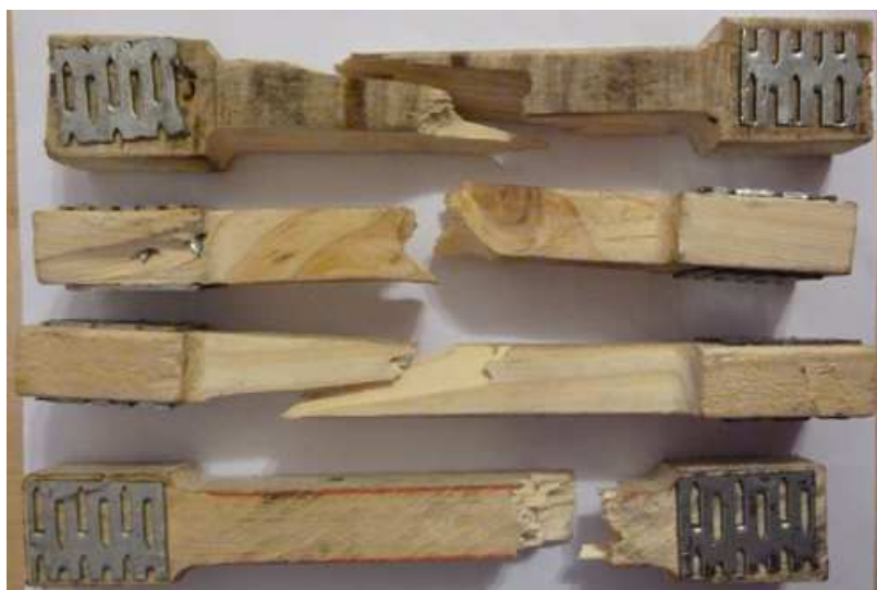
Obrázek 45 Dřevěné vzorky po tahové zkoušce
