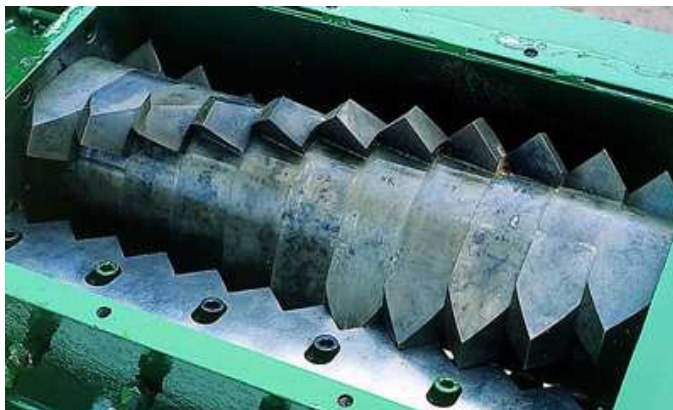
Obrázek 8 Jednohřídelový drtič opatřený segmenty
