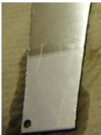
Obr. 14: Porovnání nepředupraveného (nahore) a předupraveného povrchu
