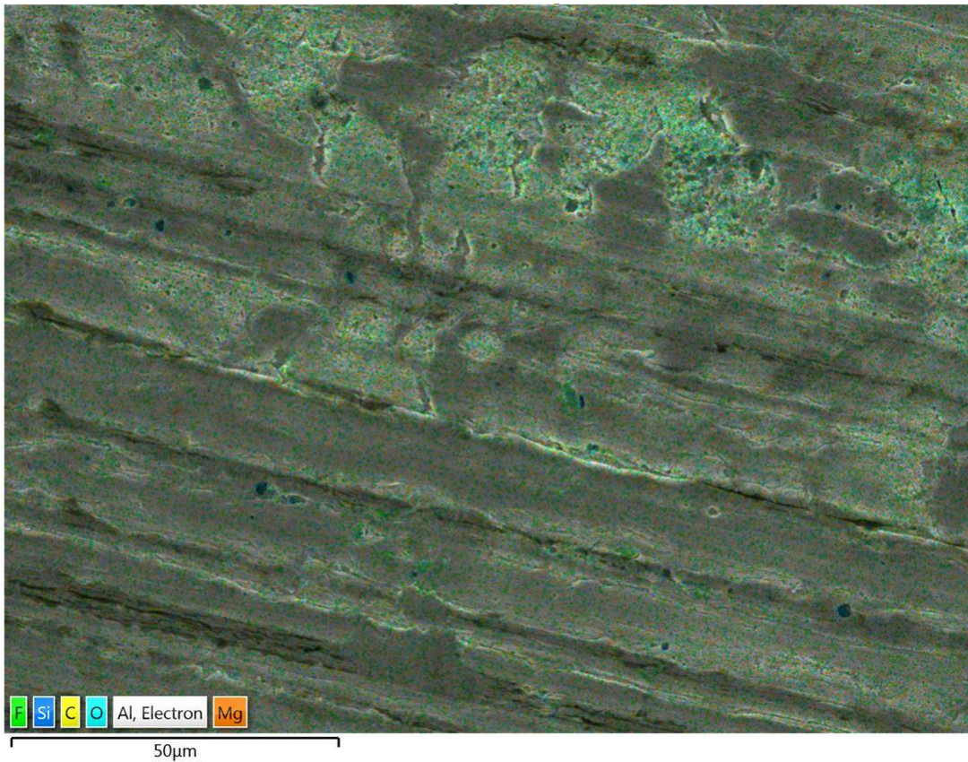
Obr. 31: Prvková mapa povrchu vzorku 6 získaná pomocí SEM s EDS při přiblížení 2000×
