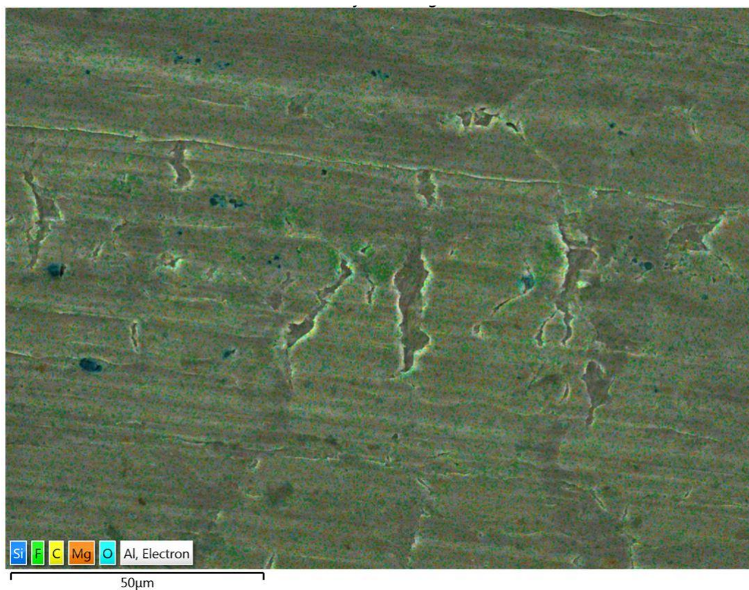
Obr. 28: Prvková mapa povrchu vzorku 5 získaná pomocí SEM s EDS při přiblížení 2000 \times
