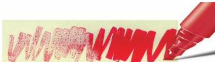
Obr. 5: Porovnání povrchu o nižší povrchové energii (vlevo) s povrchem o vyšší povrchové energii pomocí testu fixou [13]
