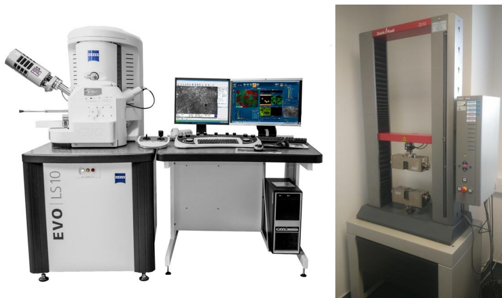
Obr. 12: Elektronový mikroskop Zeiss EVO LS-10 (vlevo) a stroj pro statické zkoušení Zwick/Roell Z010
