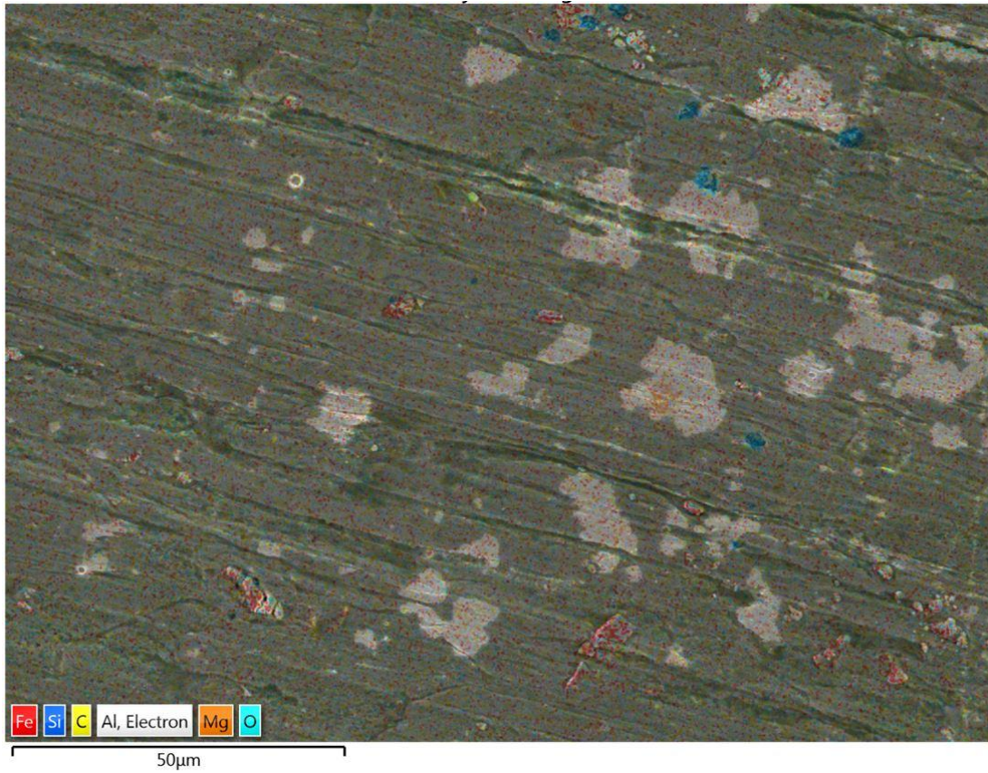
Obr. 25: Prvková mapa povrchu vzorku 4 získaná pomocí SEM s EDS při zblížení 2000×
