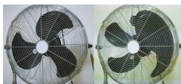
Obrázek 1.6 Porovnání globální (vlevo) a rolující (vpravo) závěrky [6]
