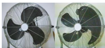
Obrázek 1.6 Porovnání globální (vlevo) a rolující (vpravo) závěrky [6]
