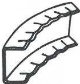
Obr. č. 33 – Zvlnění profilu během ohýbání [16]
