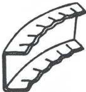
Obr. č. 33 – Zvlnění profilu během ohýbání [16]
