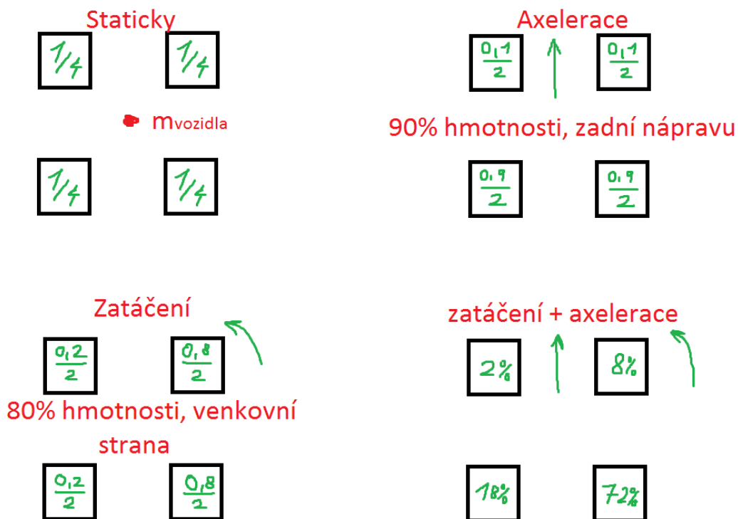
Obr. 13: Rozložení hmotnosti studentské formule na jednotlivá kola
