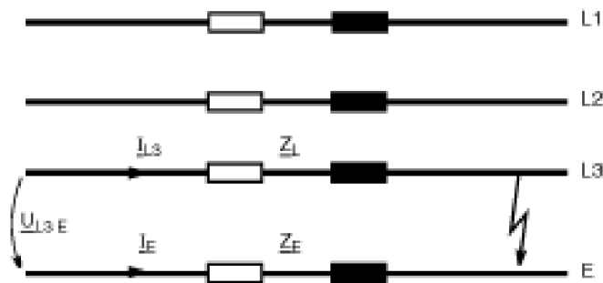
Obr. 4. 3. Zkrat smyčky vodič- země
