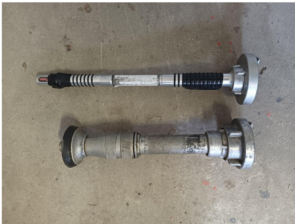
Obrázek 1.6 Clonová proudnice C52 (dole), kompaktní proudnice Excellent C52 určená pro požární sport (nahore)
