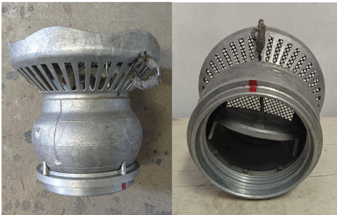
Obrázek 1.1 Typický sací koš (vlevo) a pohled na jeho zpětnou klapku (vpravo)
