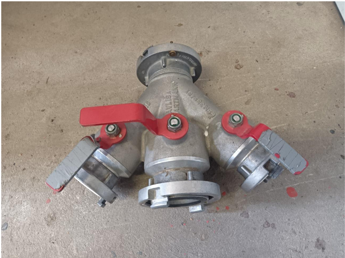
Obrázek 1.4 Rozdělovač s kulovými ventily používaný pro účely požárního sportu
