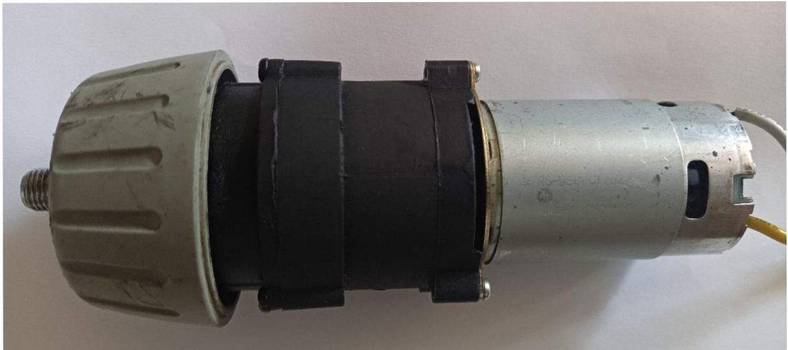
Obrázek 7.3 Sestava motoru Mabuchi RS-550PC-7527 a planetové převodovky
