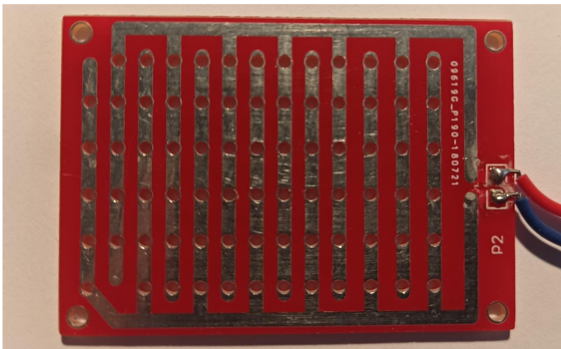
Obrázek 7.7 Senzor OKY3436 použitý ke kontrole zavodnění čerpadla
